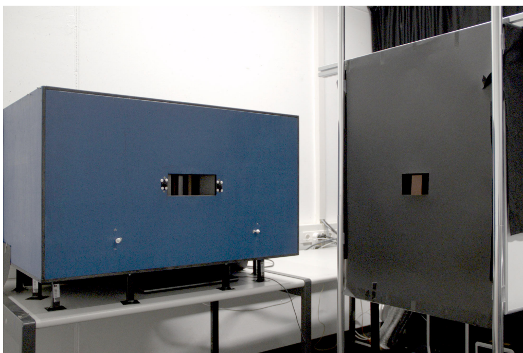
Rysunek 17: Stanowisko do badań nad kontrastem. Po lewej stronie widoczna obudowa stereoskopu opartego o wyświetlacz HDR . Z prawej strony obudowa kontenera z rzeczywistą sceną zawierającą fizyczne obiekty, która posłużyła do uzyskania fotografii dla badania opisanego w rozprawie.
